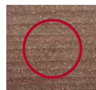
natürlicher Fasereinschluss nach mechanischer Behandlung
