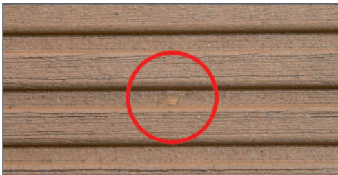
Natürlicher Fasereinschluss nach mechanischer Behandlung (z.B. Messingbürste, Stechbeitel oder durch natürliche Bewitterung)
