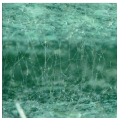
Abb. 7: Schimmelpilze auf PK 59 (H40), 40-fache Vergrößerung
