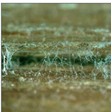
Abb. 9: Schimmelpilze auf PK 77 (Bangkirai), 50-fache Vergrößerung
